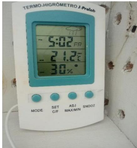
**Figura 6.** Higrômetro digital, para leitura de temperatura e umidade relativa.
