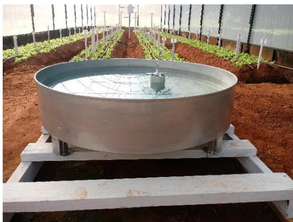
**Figura 5.** Vista geral do experimento no interior do ambiente protegido com o Tanque classe A.
